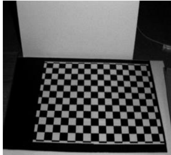
Figura 4.5: Immagine acquisita per la calibrazione. Dal confronto tra la geometria della scacchiera (nota) e cio' che compare nell'immagine si possono estrarre i parametri intrinseci e la posizione del piano di terra.
