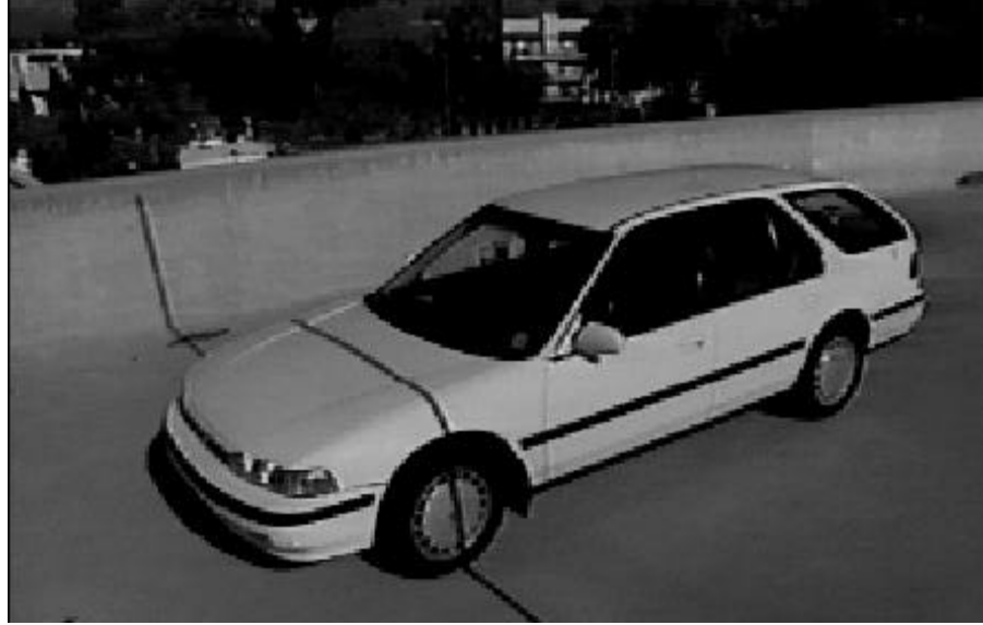
Figura 3.11: Scansione usando il sole come sorgente luminosa. Assumendo nota e fissata la posizione del punto luce (il sole), la scansione viene effettuata facendo scorrere sull'automobile l'ombra generata da un'asta.
